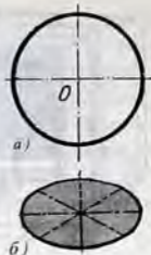
Расми 251. Табдили нақша: а – нақшаи аввал; б – нақшаи фишурдашуда (эллипс – фишурдаи давра).
